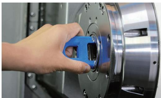
使用主軸專用清潔棒擦拭/清潔主軸
