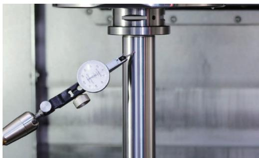
以直部最高點為基準量測主軸垂直度
